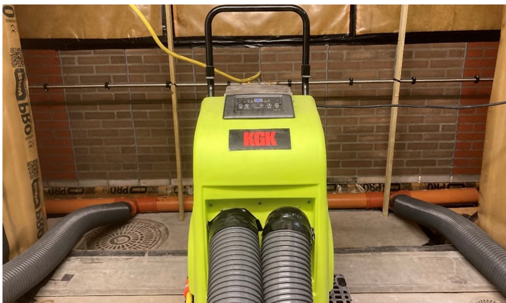
Fig. 2. Opstilling i klimakammer. De 8 mure berisles fra rør med flere åbninger. I kammeret er opstillet en kondensstørrer. Den tørre luft herfra blæses via et symmetrisk rør på gulvet, med én åbning ud for hver mur.
